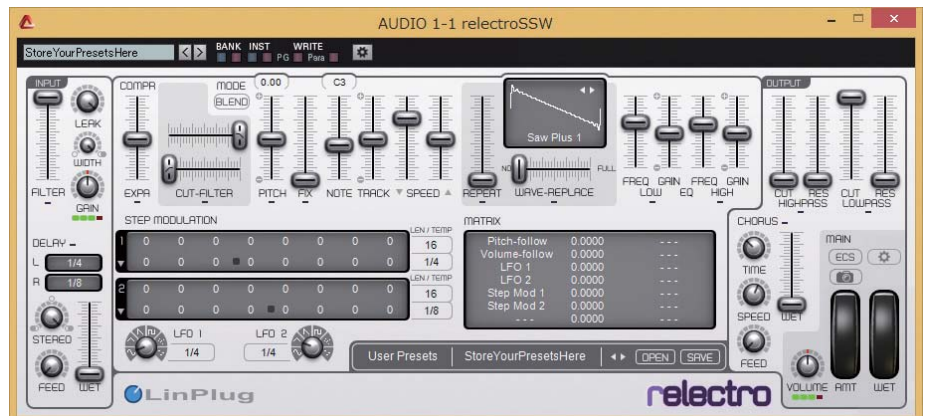
画面2 左側の入力から右側の出力に向かって、いくつかのセクションに分かれてパラメーターが配置される。音作りの中心になるのは中央上段のMAINセクションだ。その下は、メインセクションのパラメーターを可変(モジュレーション)するためのセクションになる
